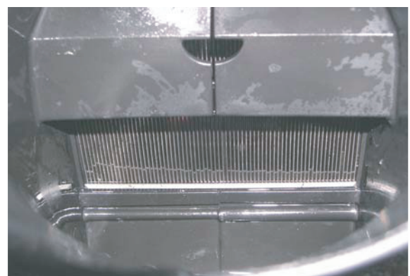
Gereinigde achterzijde van de filter na het gebruik gedurende enkele seconden van een hogedrukreiniger
