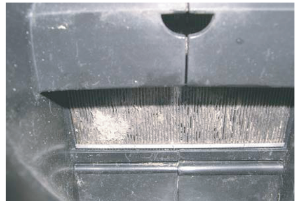
Achterzijde van een vervuilde filter
